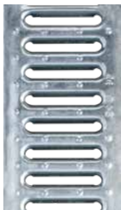
GRIGLIA ZINCATA AD ASOLE ANTITACCO FESSURA 8x82 A15 dimensioni: 124x20x1000 mm
