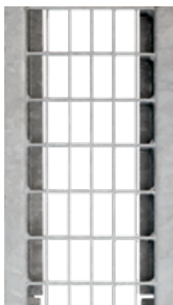
GRIGLIA ZINCATA A PONTE ANTITACCO A MAGLIA 16x30 B125 dimensioni: 124x24x1000 mm
